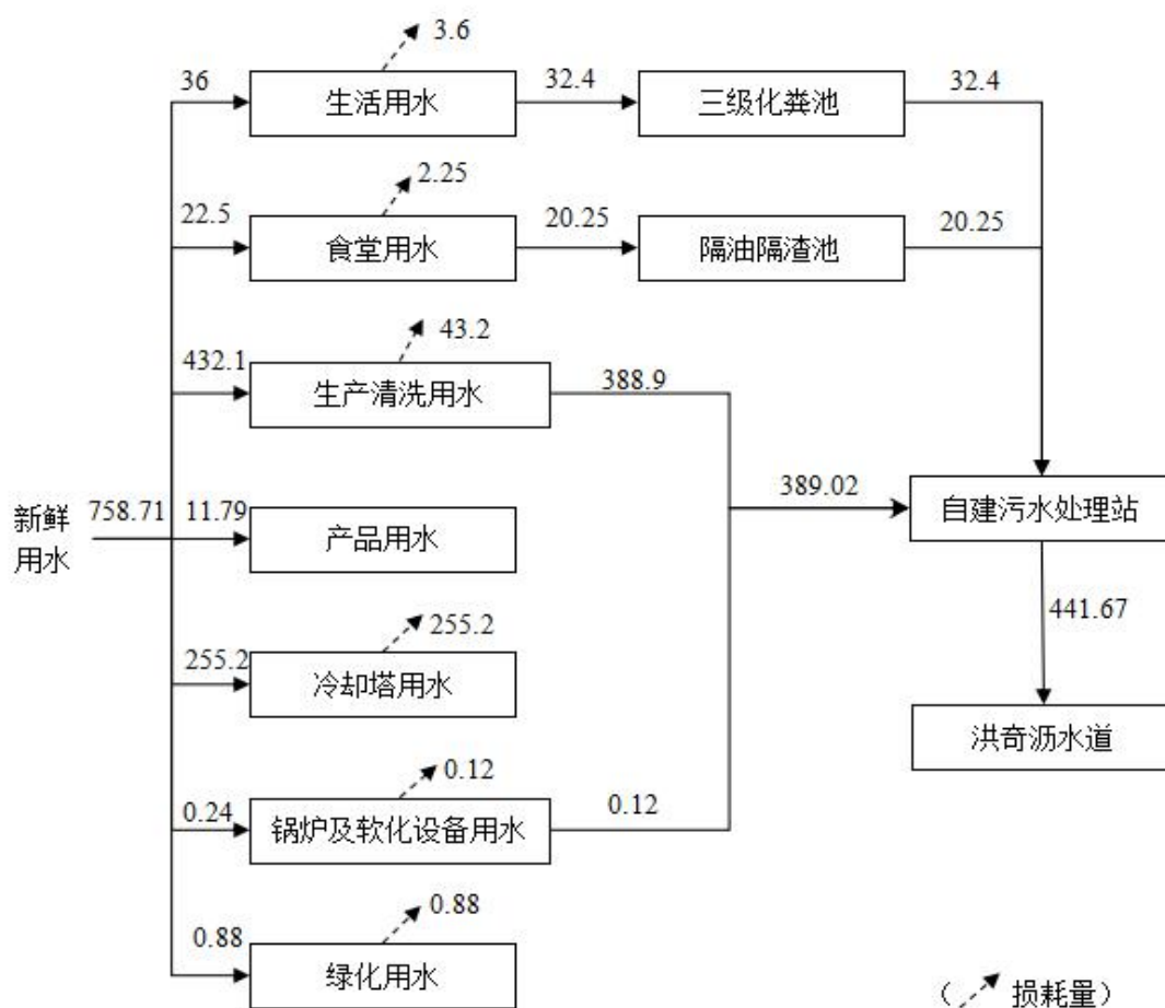
图 2-1 项目水平衡图（单位：t/d）
